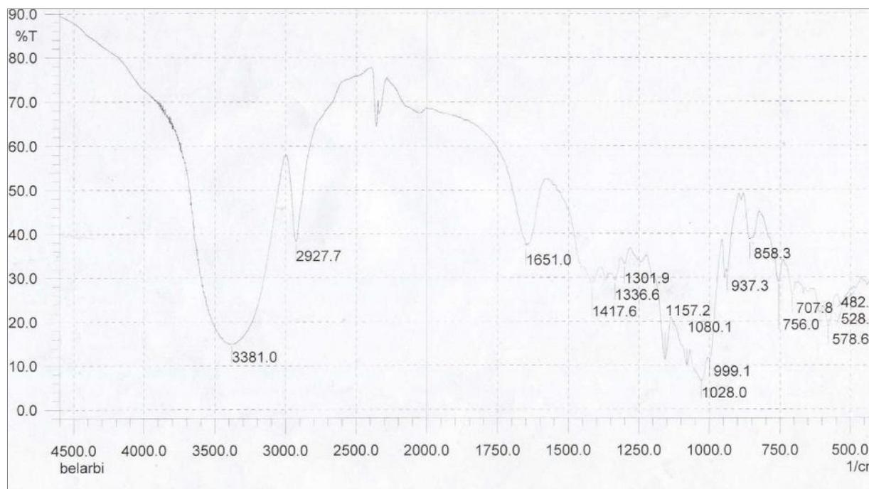
**Figure III.26** : Spectre IR de la  $\beta$ -cyclodextrine.
