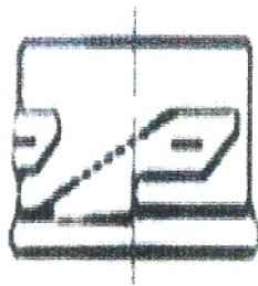
Filetage discontinu avec bren terminal pour capsules Twist-off
