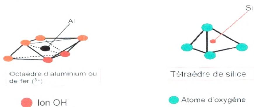
**Fig. 1 :** Représentation schématique d'un feuillet-phylosilicate 2:1 (Luckham et Rossi, 1999)
