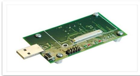
**Figure 1. 5: Photographie d'un MIB520.**
