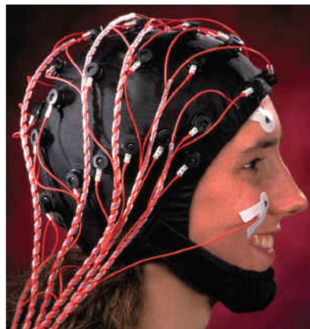
Figure II- 5 : Bonnet EEG dans sa forme physique monté sur le cuir chevelu d'un sujet
