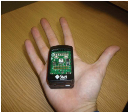
Figure II-9 : Sunspot (sur une main et attaché au bras, la taille 63x38x25mm)
