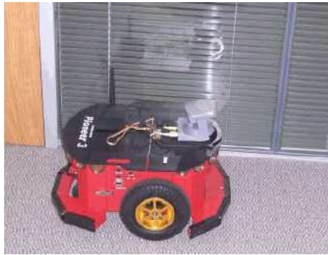
Figure II-7 : Pioneer 3DX. robot mobile autonome effectuant la détection des points de repère et leur reconnaissance
