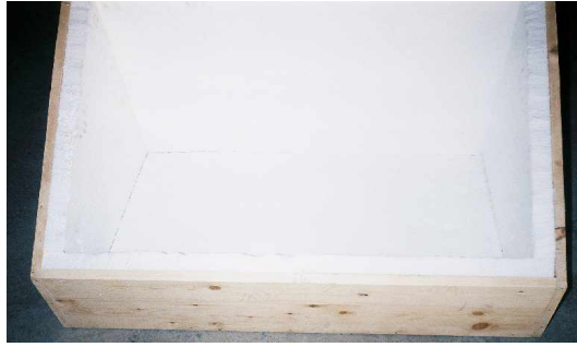
Figure 23 : Le coffre d'isolation thermique
