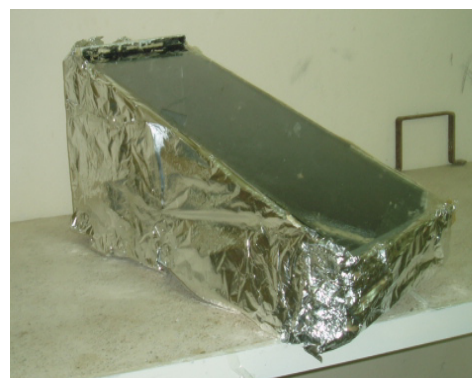
Figure 21 : distillateur solaire avec une isolation en bois bien sec peint en blanc avec et sans le film d'aluminium.
