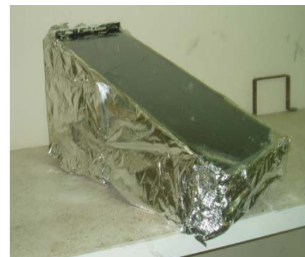
Figure (1b): Distillateur solaire réalisé
