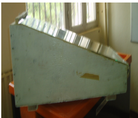
Figure 21 : distillateur solaire avec une isolation en bois bien sec peint en blanc avec et sans le film d'aluminium.
