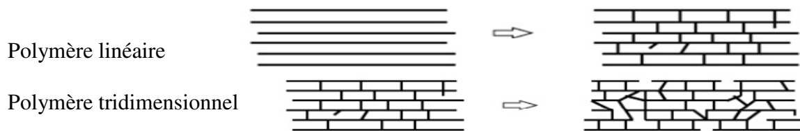
Figure 26 : Représentation schématique des processus de réticulation dans un polymère.
