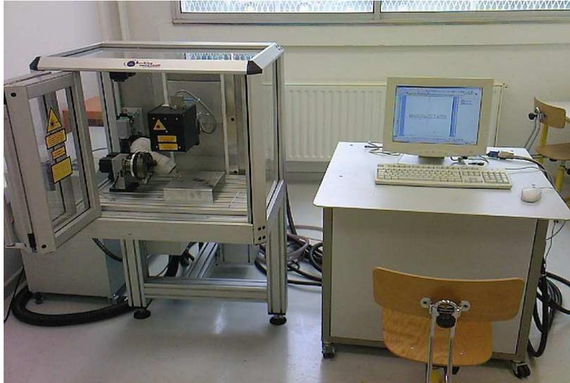
Figure VI-4 : Dispositif expérimental de la découpeuse laser
