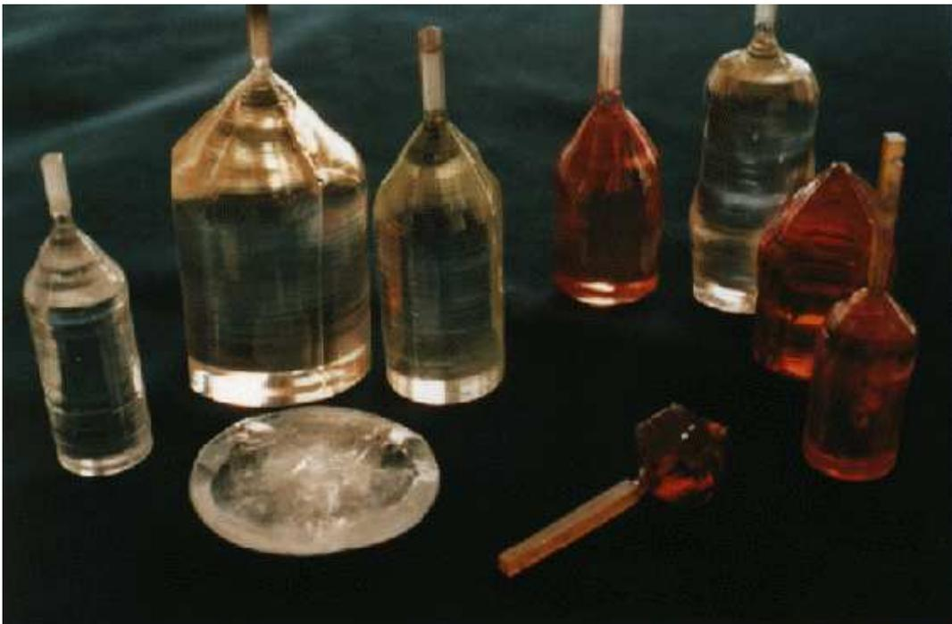
Figure I-5 : Boules de niobate de lithium pures et dopées
