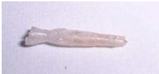
Figure I-8 : Fibre tirée par la méthode LHPG à partir d'un barreau contenant 55% de Li<sub>2</sub>O
