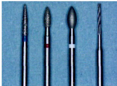
Figure 121 : fraises diamantées convexes à grains moyens puis fins pour effectuer la correction.
