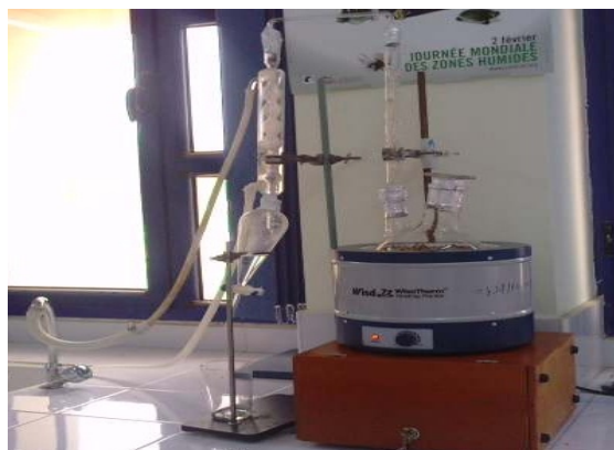
Figure 03 :Montage de l'hydrodistillateur
