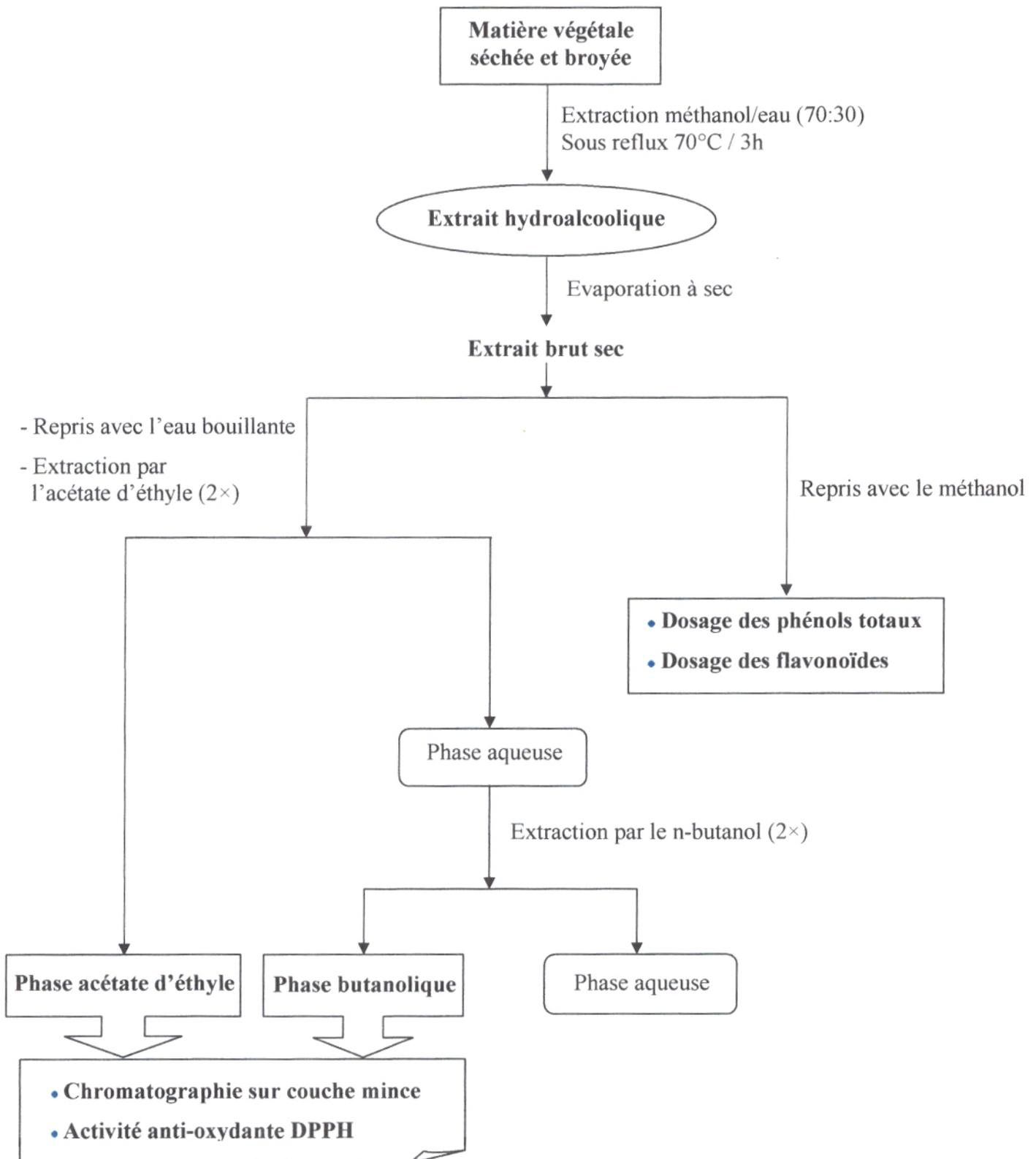
**Figure 12** : Protocole d'extraction des fractions AcOEt et n-buOH des flavonoïdes.
