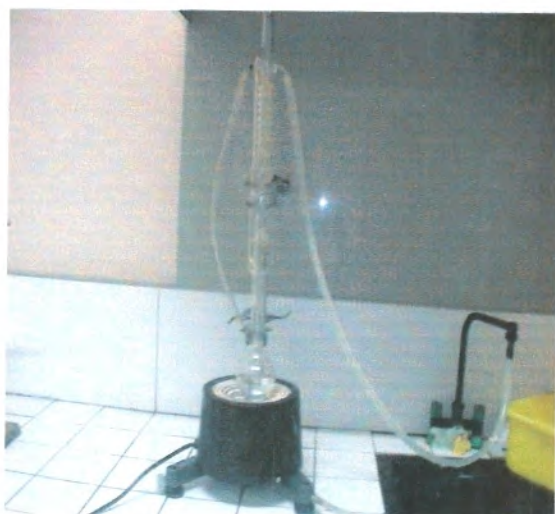
Figure 40 : Système d'extraction au Soxhlet
