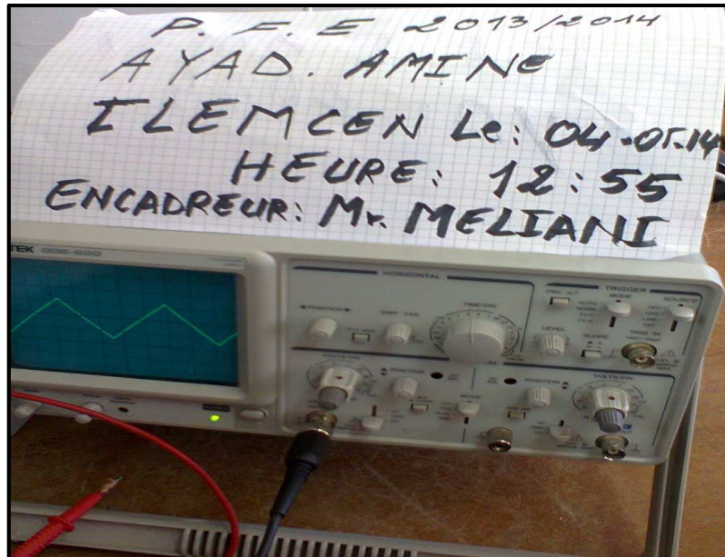
Figure 3.10 : Génération de l'onde triangulaire.
