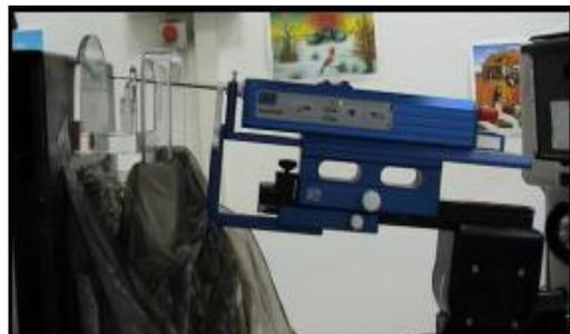
Installation du Vacora sur le système stéréotaxique en place
