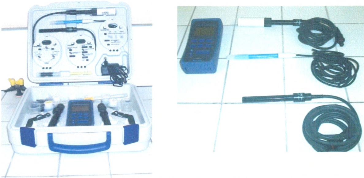
Figure 44: Mallette pour mesure des paramètres physicochimiques de l'eau Multi 340i/SET N°O: 2F30-114B22. (Photos Belhadj. 04/04/2007)
