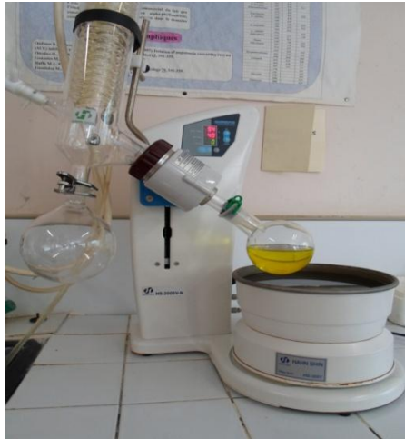
Photo 4 : Processus de l'évaporation en utilisant un évaporateur rotatif.
