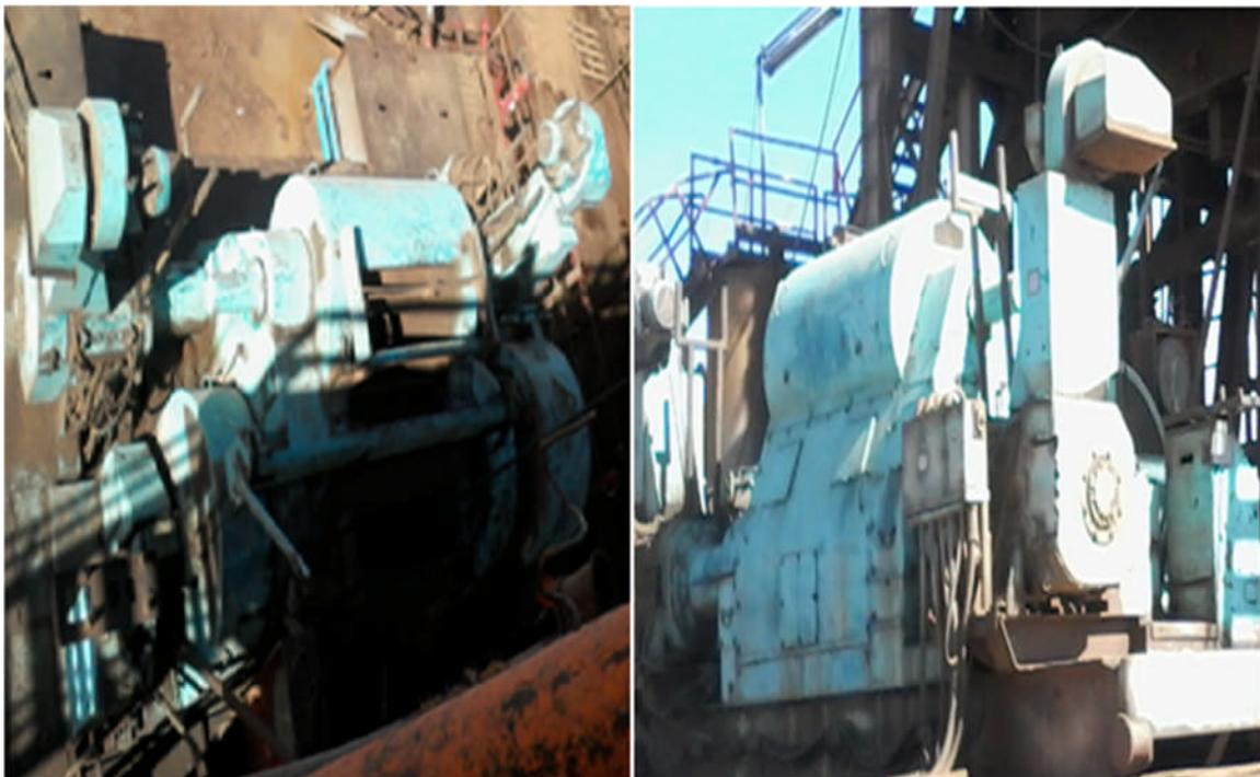
**Figure 2.3.** Treuil de forage TP 127 [1]
