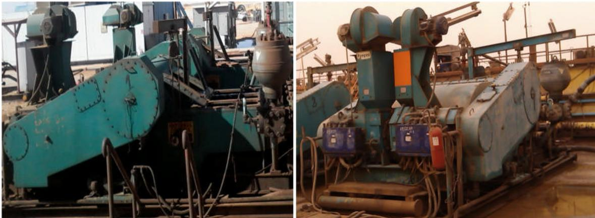
**Figure 2.19.** Pompes de forage TP 127
