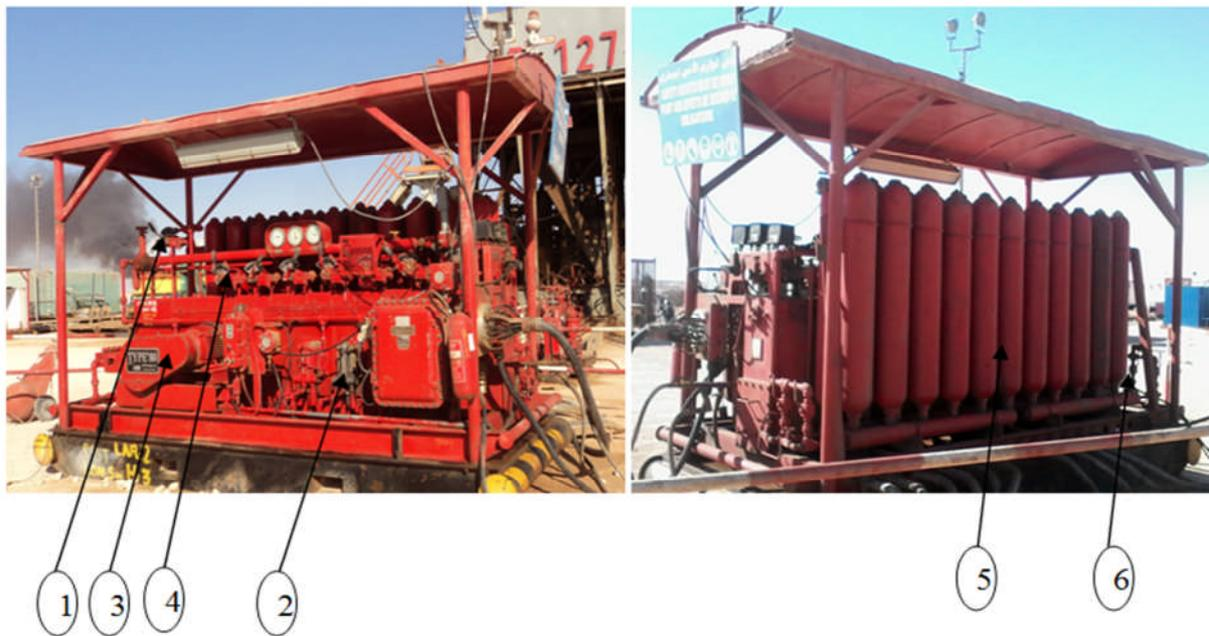
**Figure 2.23** Modules accumulateurs TP 127
