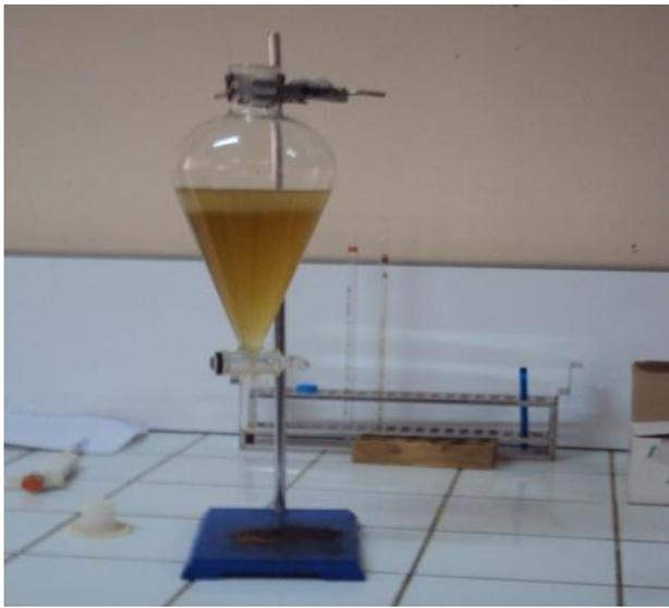
**Figure 01** : Extraction liquide-liquide à laide d'une ampoule à décanté
