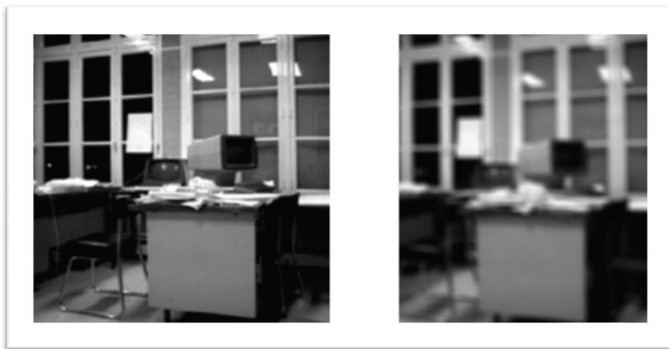
Figure III.2 : Exemple du filtre Moyenne
