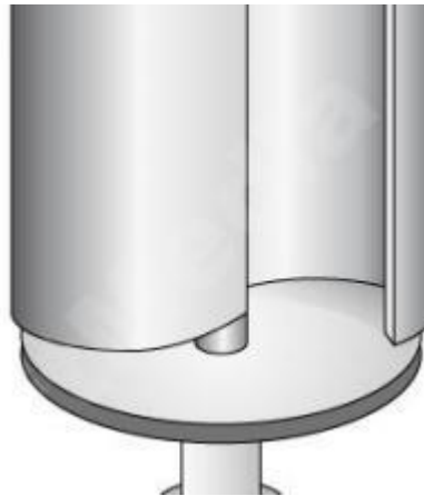
Figure I-28 éolienne domestique Savonius
