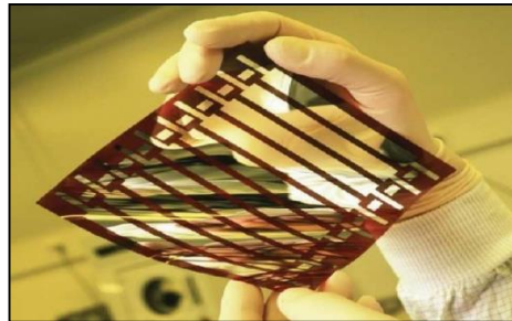
Figure I-21 Cellule solaire tout organique sur substrat souple. [14]
