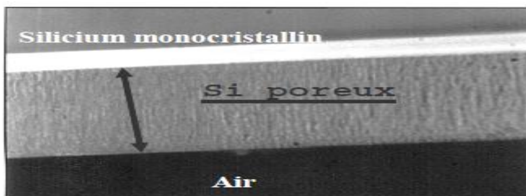
Figure III-3 : Photographie montrant la couche de silicium poreux sur la surface de la plaque de silicium (1 mm sur la photo correspond à la longueur réelle de 0,94 \mu\text{m} ) [24]
