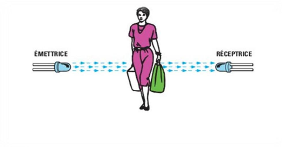
**Figure-2-3** Contrôle par photodiode.
