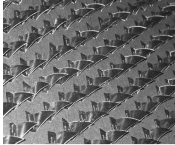
Fig. I.10 : Disposition des obstacles DCL [6]
