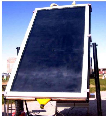
Fig. I.4 Capteur solaire plan à air exposé au soleil [ 1]
