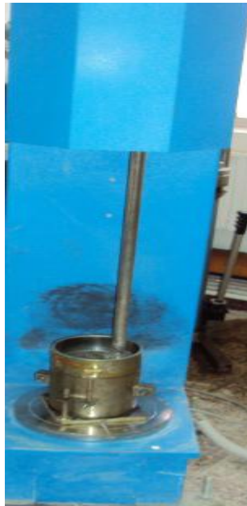
Figure III. 2: Compactage dynamique à l'aide du compacteur automatique.
