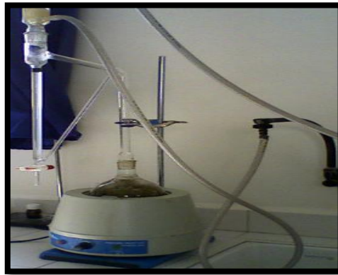
Figure12 : Hydrodistillation à l'aide d'un système de type Clevenger.
