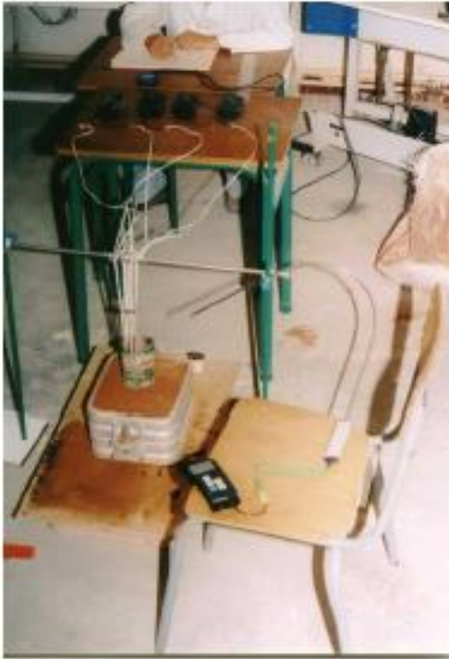
Fig 2.6 : Schéma expérimental de la coulée dans un cylindre
