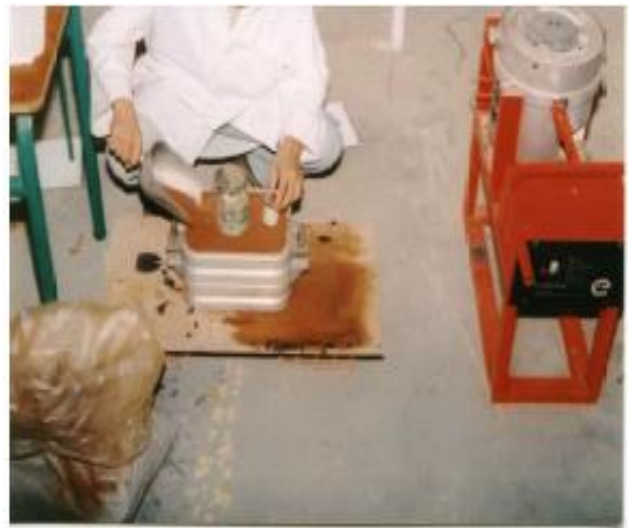
Fig 2.3 Préparation du moule et damage du sable
