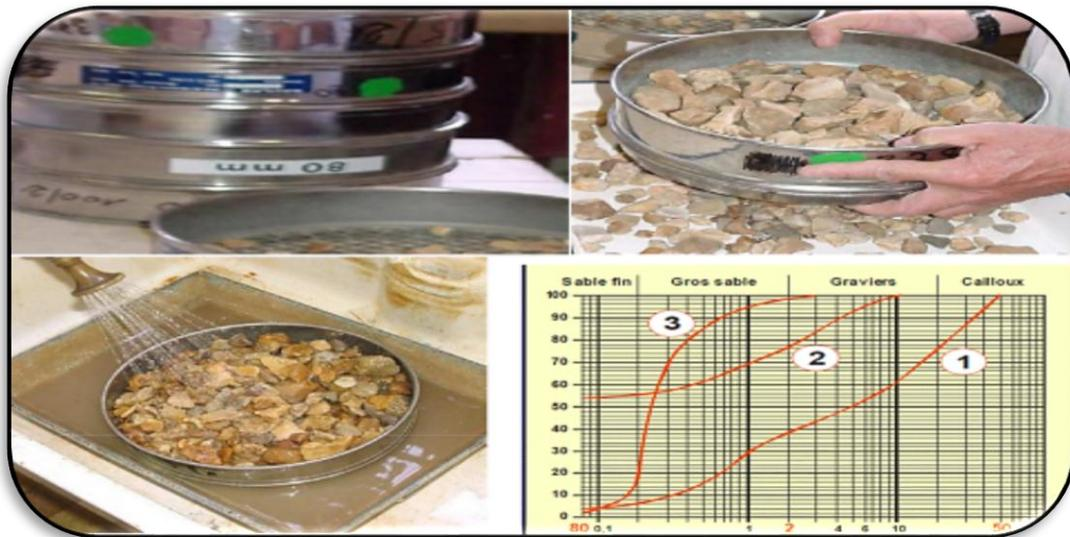
**Figure 3.1** : Analyses granulométriques.
