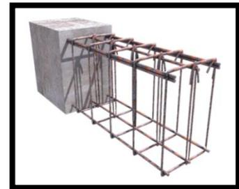
**-Les poutres :** La façon la plus simple pour porter une surface plane, comme une toiture ou un plancher, consiste à disposer une série de poutres parallèle sur lesquelles sont posés des éléments secondaires en mesure de reprendre les charges et de les transmettre aux poutres. En général se sont des poutres rectangulaires de 150x 45 cm.
