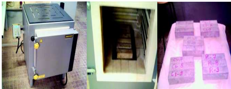
Figure 1. Dispositif de chauffage des éprouvettes
