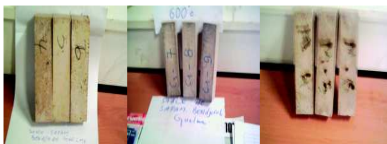
Figure 3. Etats des éprouvettes à 600°C
