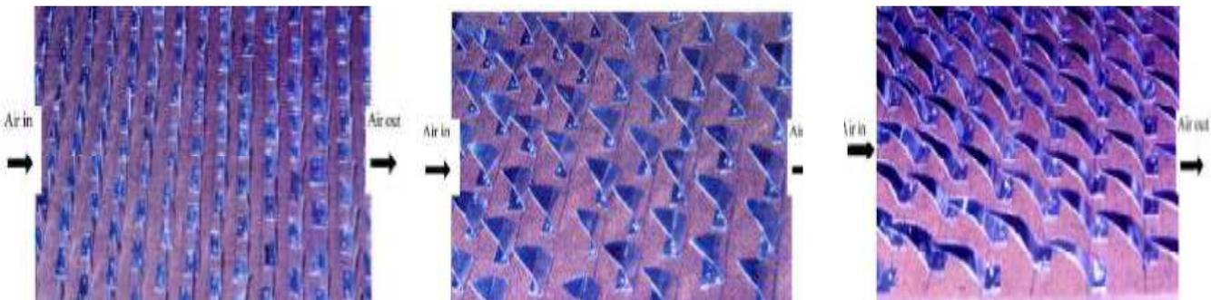
Figure II.5 : Différentes formes des ailettes ajoutées à l'absorbeur pour améliorer l'efficacité de l'absorbeur (A. Abene et al (2004)) [31].
