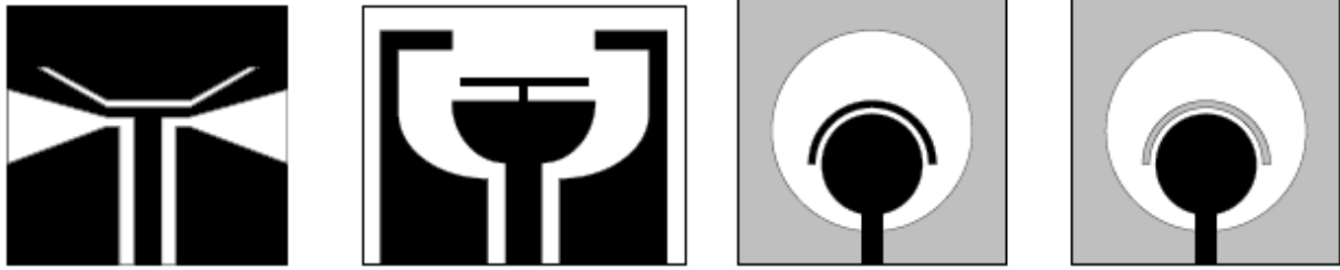
Figure II.30 : Antennes UWB à fréquence rejetée par utilisation de fentes à proximité de l'élément rayonnant
