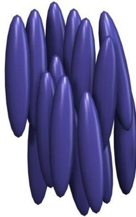
Figure I.3 : La phase nématique d'un cristal liquide.
