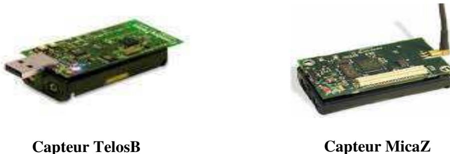
Figure I-3: Capteurs TelosB et MicaZ [10]
