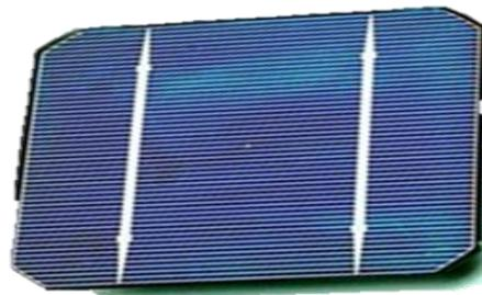
*Figure I-10.* Cellule en silicium monocristallin
