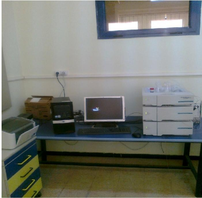
Figure N° 09 : Photo personnelle; Système d'HPLC.
