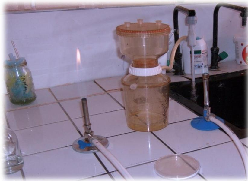
**Figure 07 : Pompe à vide pour filtration (photo originale)**
