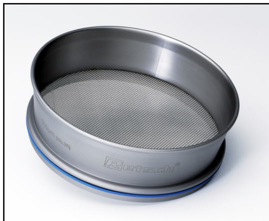
Figure 29 : Tamis d'analyses (2 mm).
