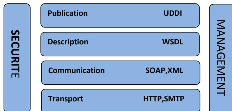
Figure 1.2 : Architecture en Pile des services Web. [13]
