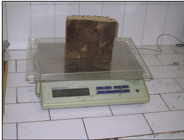
Figure 26 : Pesée des calas à l'aide d'une balance électronique (Original)
