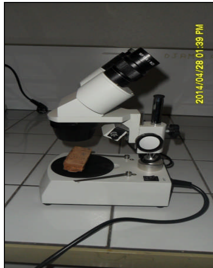
Figure 25 : Mesure des accroissements au micromètre monté sur une loupe (original)
