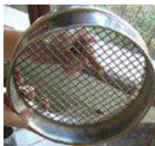
Fig n°12: Photo représentative d'un tamis utilisé pour l'analyse granulométrique
