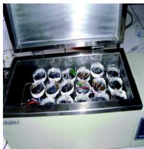
**Fig. 1.** Bêchers immergés dans le thermostat
