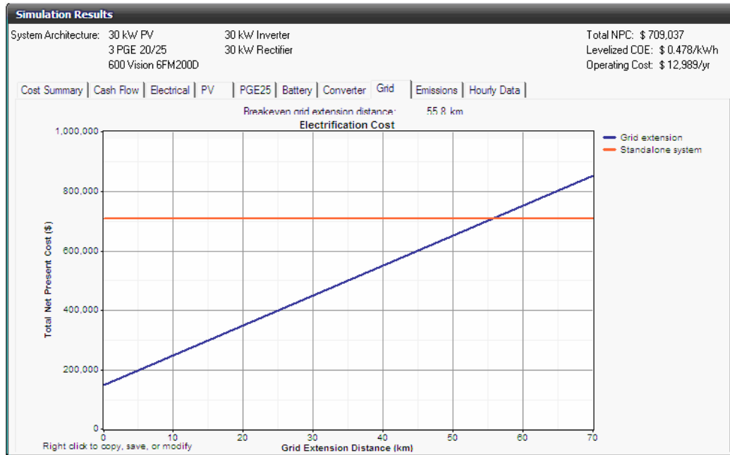
Figs.54 : comparaison entre le coût d'extension du réseau et le système PV/éolien
