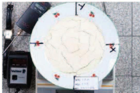
**Figure 4.** Réseau fissuré du kaolin P300 à  $t= 8h$
