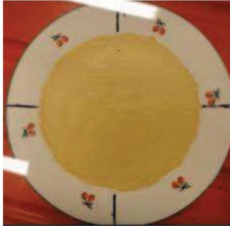
**Figure 1.** *Échantillon et plan de contact porcelaine/argile*
