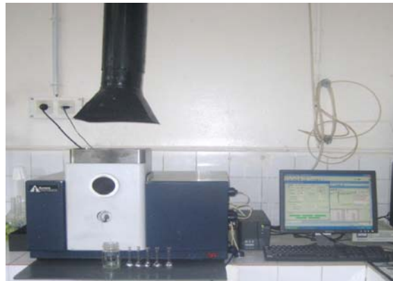
Figure 20: Spectrophotométrie d'absorption atomique à flamme de type AURORA AI 1200 (Usine ALZINC, 2010).
