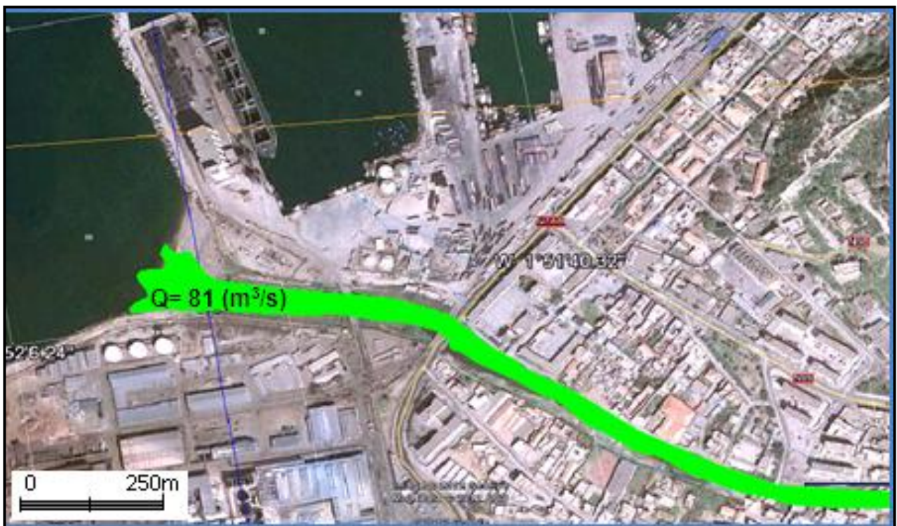
Figure IV.27 : Localisation des zones inondées de la ville de Ghazaouet après l'aménagement pour un débit de 81 \text{ (m}^3/\text{s)}
