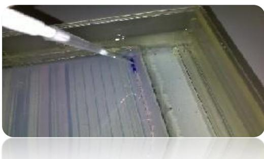
**Figure. II. 6 :** photo de dépôt de l'échantillon.
