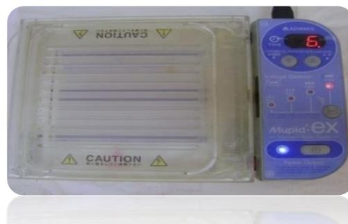
**Figure. II. 7 :** photo représente le déroulement de la migration de l'ADN par électrophorèse.
