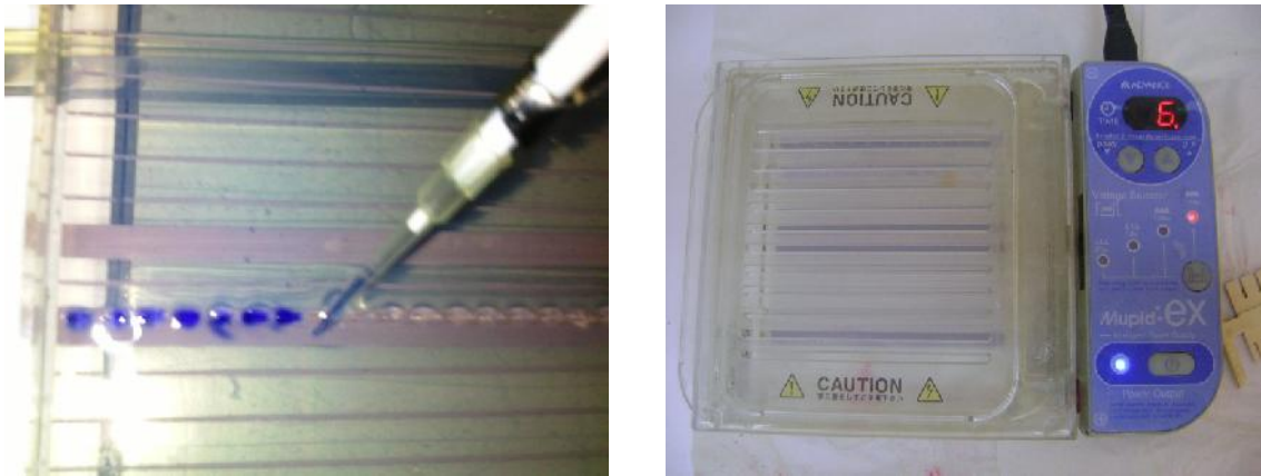
Fig. II.3 : Dépôt de l'ADN dans les puits et migration par électrophorèse
