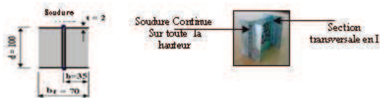
Figure 1. Section reconstituée transversale en I
