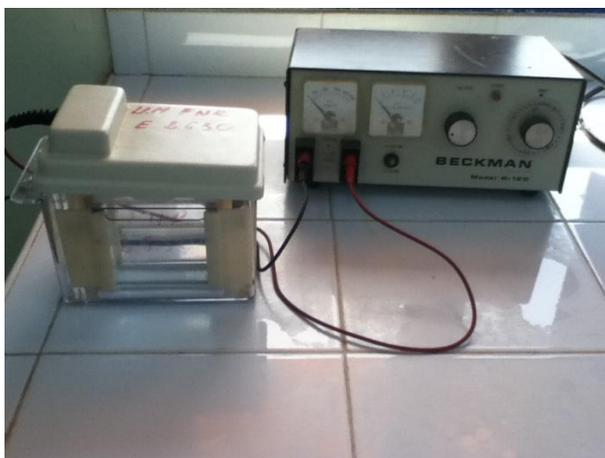
**Figure 2.8 Ensemble du dispositif d'électrophorèse SDS-PAGE**
