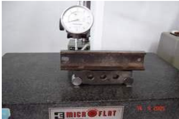
Fig.3.5. Contrôle de la rectitude de la glissière
