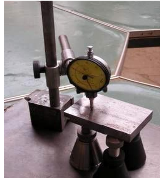
Fig3.2b. Contrôle de la rectitude sur marbre de la semelle
