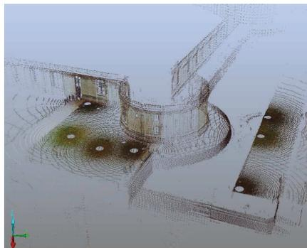
Figure 4 : Emplacement des 7 stations pour le relevé au laser scanner
