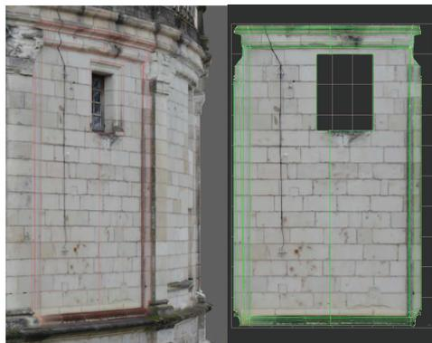
Figure 10 : Exemple de dépliage 2D d'un objet photomodélisé avec ImageModeler
